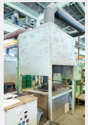
すず溶解槽と 電気式カートリッジヒーターの制御盤
